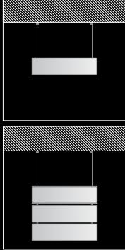
**IT** | uno speciale adattatore consente, unendo due pannelli murali, di ottenere velocemente un pannello a soffitto. in tale versione sospesa il materiale per il montaggio è incluso. in alternativa, con un sostegno rigido al posto del cavo di acciaio, potrà utilizzare signcode anche in ambienti e condizioni particolari.
