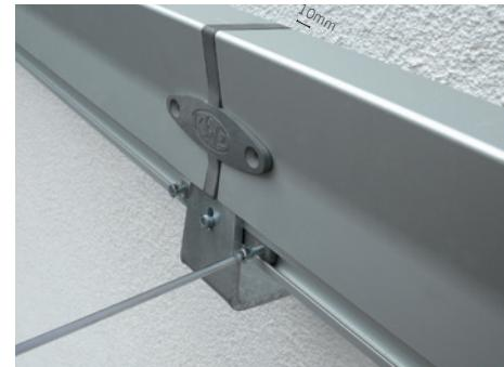
il connettore angelframe, per composizioni modulari, deve essere fissato ad un gancio murale. i profili risulteranno così connessi grazie a questo accessorio. in caso di utilizzo del connettore AFCON2, considerare 10mm in meno, per ogni connettore, sulla lunghezza dei profili.
