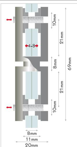
**IT** connettore in acciaio per pannelli. morsetto in acciaio inox per la connessione verticale di pannelli. il fissaggio avviene tramite le brugole. anellini di protezione inclusi. fissaggio: connettore di pannelli. materiale: acciaio inox AISI303 lucidato.
