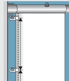
**IT** asta portabandiera cilindrica con dispositivo interno per issare la bandiera, braccio girevole telescopico, adatta per essere interrata nel cemento. la bandiera viene issata verticalmente sull'asta grazie ai tiranti. peso antisollevamento. riavvolgimento della bandiera facile e veloce. alluminio anodizzato di alta qualità in colore argento. dimensioni consigliate della bandiera: 3000x1200mm.
