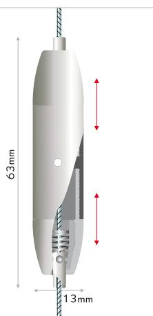
**IT** tensionatore per cavi con sistema autobloccante. per un'ottima tensione di cavi molto lunghi. inserire l'estremità del cavo in link, dove il sistema autobloccante lo tratterrà, e regolare la tensione avitandolo. il forellino centrale garantisce un avitamento più stretto. spessore del cavo: max Ø1,8mm.
