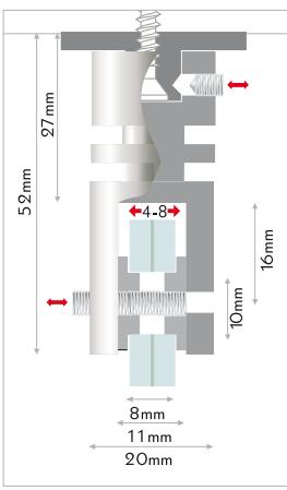
**IT** morsetto a bandiera in acciaio per parete o soffitto. per montaggi di pannelli a bandiera o direttamente a soffitto. il fissaggio del pannello avviene tramite le brugole. anelli di protezione inclusi. fissaggio: morsetto a bandiera con sistema a brugola. materiale: acciaio inox AISI303.
