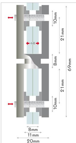
**IT** connettore in acciaio per pannelli. morsetto in acciaio inox per la connessione verticale di pannelli. il fissaggio avviene tramite le brugole. anellini di protezione inclusi. fissaggio: connettore di pannelli. materiale: acciaio inox AISI303
