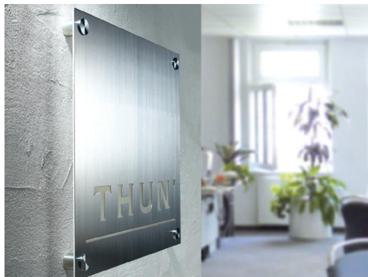
**IT** sistema di fissaggio in acciaio con chiusura laterale di sicurezza per piccoli formati. fissare il distanziale alla parete, posizionare il pannello, inserire la testina nel foro e attraverso il pannello e completare il fissaggio tramite la brugola laterale di sicurezza, che impedisce che la targa possa venir manomessa o smontata. materiale: acciaio inox AISI304, testina con sfaccettature.
