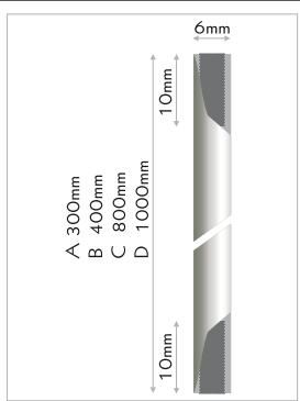
**IT** astine modulari. robuste astine disponibili in 4 diverse lunghezze, con filetto M4 e brugole per l'avvitamento. fissaggio: sistema a brugola. materiale: ottone cromato. lunghezze: 300mm, 400mm, 800mm, 1000mm. spessore dell'astina: Ø6mm.
