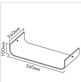
**IT** ripiano per fly style. ripiani leggermente curvi per sistemi su astine con fori laterali per il fissaggio. esterno lucido, interno satinato. supporti in ottone cromato per il montaggio laterale sulle astine inclusi. materiale: acrilico color ghiaccio, spessore 6mm, raggio 50mm. fori laterali: Ø4mm.
