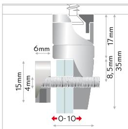
**IT** morsetto variabile a bandiera per parete o soffitto. per montaggi di pannelli a bandiera o direttamente a soffitto. morsetto flessibile per pannelli con diversi spessori. il fissaggio del pannello avviene tramite le brugole. fissaggio: morsetto variabile a bandiera con sistema a brugola. materiale: ottone cromato.
