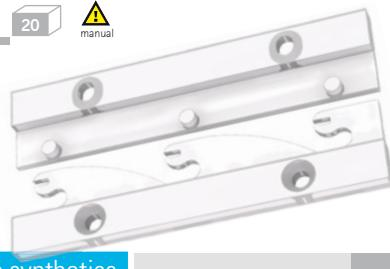
**IT** binario di fissaggio laterale da incollare, invisibile. montare una parte a parete, l'altra incollarla con biadesivo, silicone o colla sul pannello. fissaggio con viti anche possibile. i pannelli sono così facilmente intercambiabili. materiale: acrilico trasparente.
