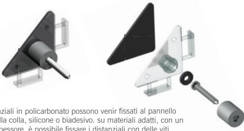
i distanziatori in policarbonato possono venir fissati al pannello con della colla, silicone o biadesivo, su materiali adatti, con un certo spessore, è possibile fissare i distanziatori con delle viti
