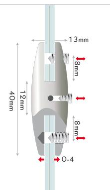
**IT** pinza laterale doppia. morsetto laterale per il fissaggio su cavi di due pannelli affiancati. il fissaggio al pannello e al cavo avviene tramite le brugole. spessore del cavo: max. Ø1,8mm.
