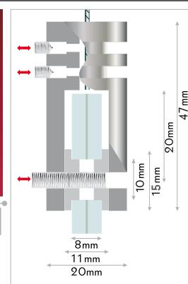
**IT** morsetto in acciaio per pannelli con cavi. morsetto per cavi di acciaio o di nylon o per catenelle. il fissaggio del pannello e del cavo avviene tramite le brugole. anelli di protezione inclusi. fissaggio: morsetto per pannelli, sistema a brugola. materiale: acciaio AISI303, testina con sfaccettature. spessore del pannello: max. 8mm o 11mm senza anelli. spessore del cavo: max. Ø1,8mm.
