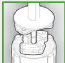
B il sistema frenante: integrato nel meccanismo, il freno regola la sua azione frenante in base alla velocità di rotazione dell'avvolginastro. il nastro viene riavvolto con la stessa velocità dall'inizio alla fine. si evitano così ferite alle mani e alle dita a causa di un riavvolgimento incontrollato e troppo veloce.
