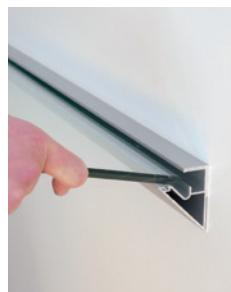
montaggio semplice e senza utensili: il peso stesso e il listello di pvc all'interno del profilo mantengono i ripiani stabilmente in posizione.
