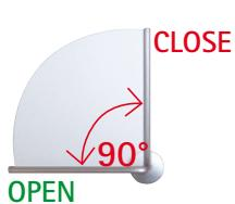
**IT** sistema variabile zigrinato, chiusura di sicurezza frontale, veloce. montare i distanziali alla parete, inserire la molla. inserire le testine nel pannello e le rondelle in pvc. le rondelle assicurano un fissaggio perfetto del pannello. premere il pannello con le testine nei fori dei distanziali. per fissare avvitare le testine di 90°. il fissaggio è anche possibile centrale nel pannello grazie al sistema di fissaggio frontale tramite la testina.
