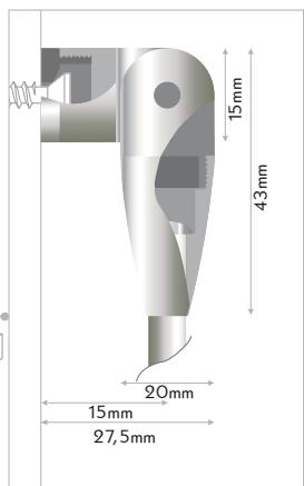
**IT** tirante snodabile di 180° per astine. fissare il tirante a soffitto oppure a parete, inserire la barra nel cono e la brugola all'estremità dell'astina, avvitare barra e cono al tirante. spessore dell'astina: Ø6mm.
