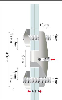
**IT** pinza laterale doppia regolabile. morsetto laterale per il fissaggio su cavi di due pannelli affiancati. il fissaggio al pannello e al cavo avviene tramite le brugole. spessore del cavo: max. Ø1,8mm.
