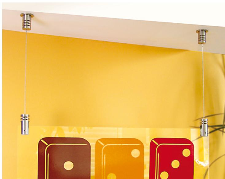
**IT** tirante in acciaio per cavi con sistema a brugola. fissaggio a soffitto universale, in acciaio inox, per cavi di acciaio o di nylon o per catenelle. montare il tirante a soffitto, inserire il cavo nel morsetto e fissarlo con le brugole. fissaggio: tirante per cavi, sistema a brugola. materiale: acciaio AISI303, testina con sfaccettature. distanza dal soffitto: 35mm. spessore del cavo: max. Ø1,8mm.
