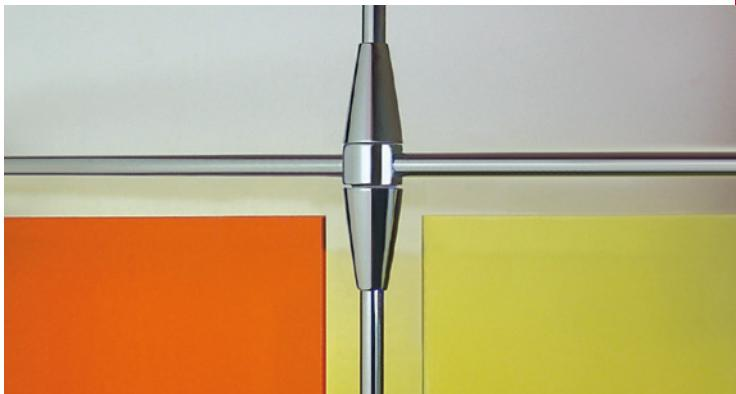
**IT** connettore ad incrocio per astine. per la connessione a croce di tre astine. inserire due astine nelle estremità e la terza perpendicolarmente, nel foro centrale. effettuare il fissaggio con la brugola, che rimane nascosta alla vista. spessore dell'astina: Ø6mm
