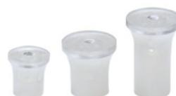
**IT** sistema di fissaggio a pressione, da incollare, invisibile, senza fori. fissare la bussola a parete, incollare la testina al pannello con biadesivo, silicone o colla, agganciare il pannello alla bussola. materiale: acrilico bianco/trasparente.
