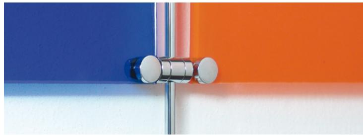
**IT** morsetto laterale doppio e regolabile per pannelli su astine. il fissaggio all'astina e al pannello avviene tramite brugole. le parti finali del morsetto sono regolabili per il fissaggio orizzontale, verticale o obliqui dei pannelli. fissaggio: morsetto laterale doppio per pannelli, girevole. materiale: ottone cromato. spessore del pannello: 0-10mm, spessori maggiori con brugole più lunghe. spessore dell'astina: Ø6mm.
