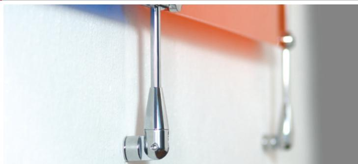
**IT** connettore snodabile di astine. utilizzabile per il fissaggio a parete e come connettore per 2 astine. il giunto, ruotabile di 180°, permette di montare le astine non solo ad angolo retto ma anche in altre direzioni. agganciare le due parti di arte alle astine, mettere la brugola all'estremità delle astine e avvitare per collegarle. spessore dell'astina: Ø6mm.
