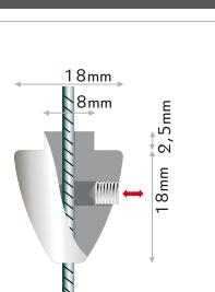
**IT** supporto per ripiani su cavi, sistema a brugola. per fissare su cavi ripiani e mensole in modo facile e sicuro. infilare il cavo e fissarlo con la brugola. che sia in negozio, in ufficio o a casa: spessore del cavo: max. Ø1,8mm.
