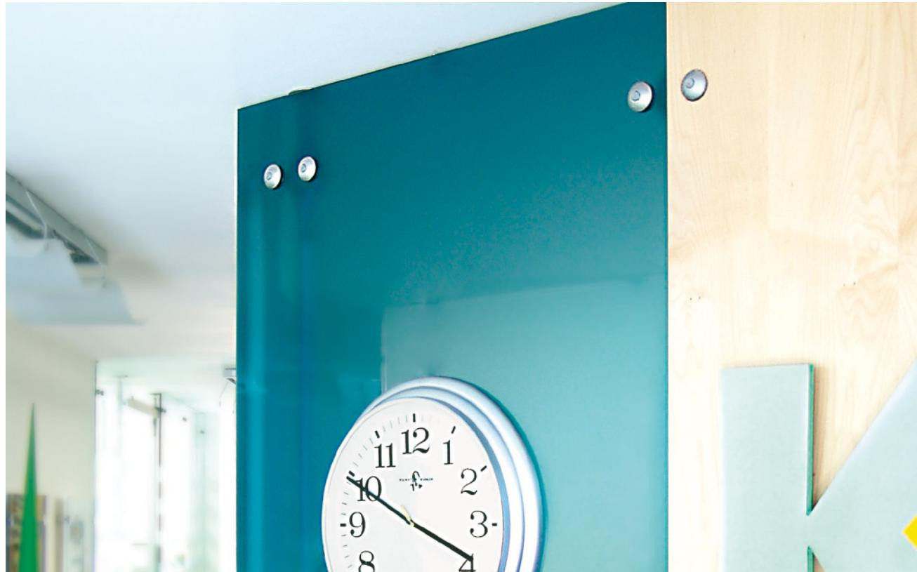
**IT** sistema di fissaggio per lastre di grandi dimensioni e spessori, adatto anche per l'utilizzo in ambienti architettonici. fissaggio: sistema di fissaggio a vite, montaggio frontale. materiale: ottone cromato, vite a brugola in acciaio inox, rondelle in poliuretano.
