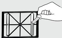
fissaggio nastro biadesivo
