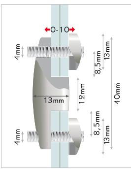
**IT** connettore bifacciale per pannelli, sistema autobloccante. morsetto in ottone lavorato per la connessione verticale di due panelli. connettore flessibile per pannelli con diversi spessori. il fissaggio avviene tramite le brugole. materiale: ottone cromato. spessore del cavo: max. Ø1,8mm.
