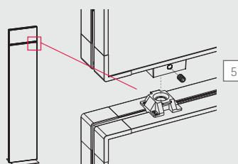
grazie ad ipoint connector il vostro espositore ipoint diventa modulare. basta inserire i dadi nei profili prima di effettuare il montaggio, in modo da poter aggiungere alla struttura tutta una serie di elementi in modo semplice e veloce.
