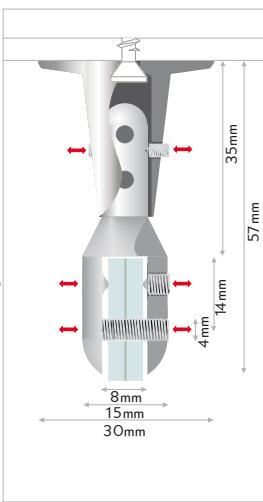
**IT** morsetto a bandiera per parete o soffitto. per montaggi di pannelli a bandiera o direttamente a soffitto. il fissaggio del pannello avviene tramite le brugole. fissaggio: morsetto a bandiera con sistema a brugola. materiale: ottone con cromatura.
