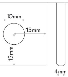
**IT** pannelli in vetro. elegante vetro temperato con bordi lucidati e sfaccettati con un'angolatura di 45°. da utilizzare singolarmente o in coppia per sistemi a sandwich. i pannelli sono già forati e completi con anelli di protezione. materiale: vetro temperato.
