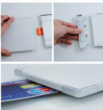
inserire nella cornice il pannello in alluminio o in PS trasparente e chiudere il sistema lateralmente. per aprire la cornice basta premere sul gancio di sicurezza con una tessera plastificata tipo carta di credito.
