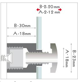
**IT** sistema di fissaggio a vite per grandi pannelli che offre una maggiore distanza dal muro. specifica conformazione per un facile posizionamento del pannello. resistente alle impronte lasciate dalle dita. fissaggio: sistema di fissaggio a vite, montaggio frontale. materiale: alluminio anodizzato in oro, argento, nero e titanio.
