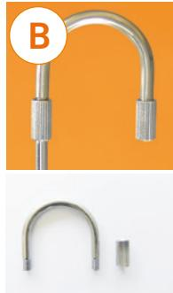
**IT** arco per antenna. connettore 180° con bussola per antenna. semplicemente avvitare. materiale: acciaio inox, bussola ottone nichelato, con filettatura per il sostegno delle antenne. confezione: 5pz.
