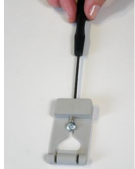
l'angolo della struttura può anche essere avvitato al pannello.
