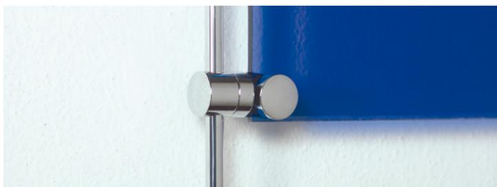
**IT** morsetto laterale regolabile per pannelli su astine. il fissaggio all'astina e al pannello avviene tramite brugole. la parte finale del morsetto é regolabile per il fissaggio orizzontale, verticale o obliquo del pannello. fissaggio: morsetto laterale per pannelli, girevole. materiale: ottone cromato. spessore del pannello: 0-10mm, spessori maggiori con brugole piú lunghe. spessore dell'astina: Ø6mm.
