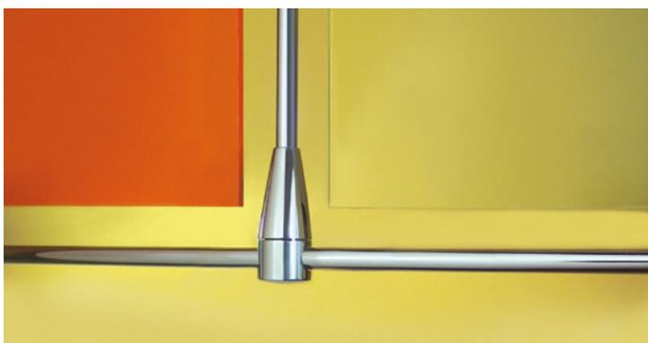
**IT** connettore a T per 2 astine. inserire un'astina nel foro alla base del cono e l'altra perpendicolarmente all'estremità a punta di tripla. effettuare il fissaggio con la brugola. per connessione semplici di due astine. spessore dell'astina: Ø6mm
