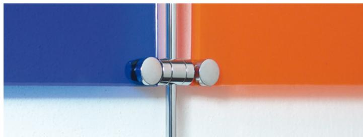
**IT** morsetto laterale doppio e regolabile per pannelli su astine. il fissaggio all'astina e al pannello avviene tramite brugole. le parti finali del morsetto sono regolabili per il fissaggio orizzontale, verticale o obliquo dei pannelli. fissaggio: morsetto laterale doppio per pannelli, girevole. materiale: ottone cromato. spessore del pannello: 0-10mm, spessori maggiori con brugole piú lunghe. spessore dell'astina: Ø6mm.
